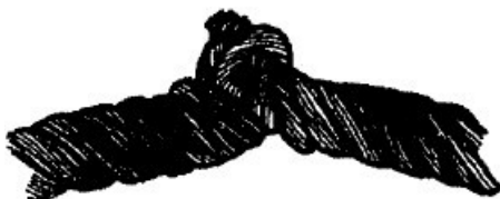
Рисунок а. Волнистость каната деформация
