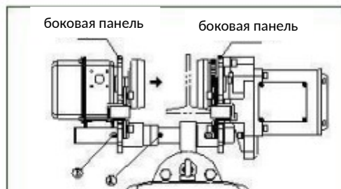
Схема присоединения подвесной тележки к балке
