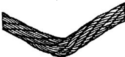
Рисунок е. Выдавливание проволок прядей: а - в одной пряди; б - в нескольких прядях
